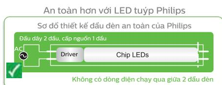
Thiết kế của Philips vừa tương thích với mọi kiểu đi dây (1 đầu và 2 đầu) và an toàn về điện vì không có dòng điện giữa 2 đầu đèn
